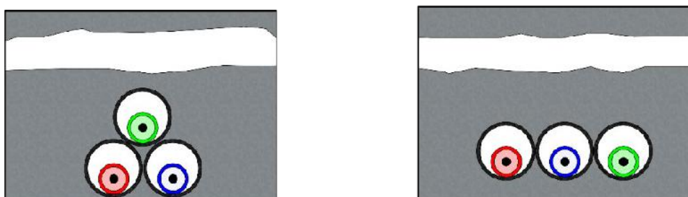
شکل ۳-۱۹- آرایش کابل‌های تک‌ رشته‌ای به صورت نصب در داکت‌های زیرزمین
