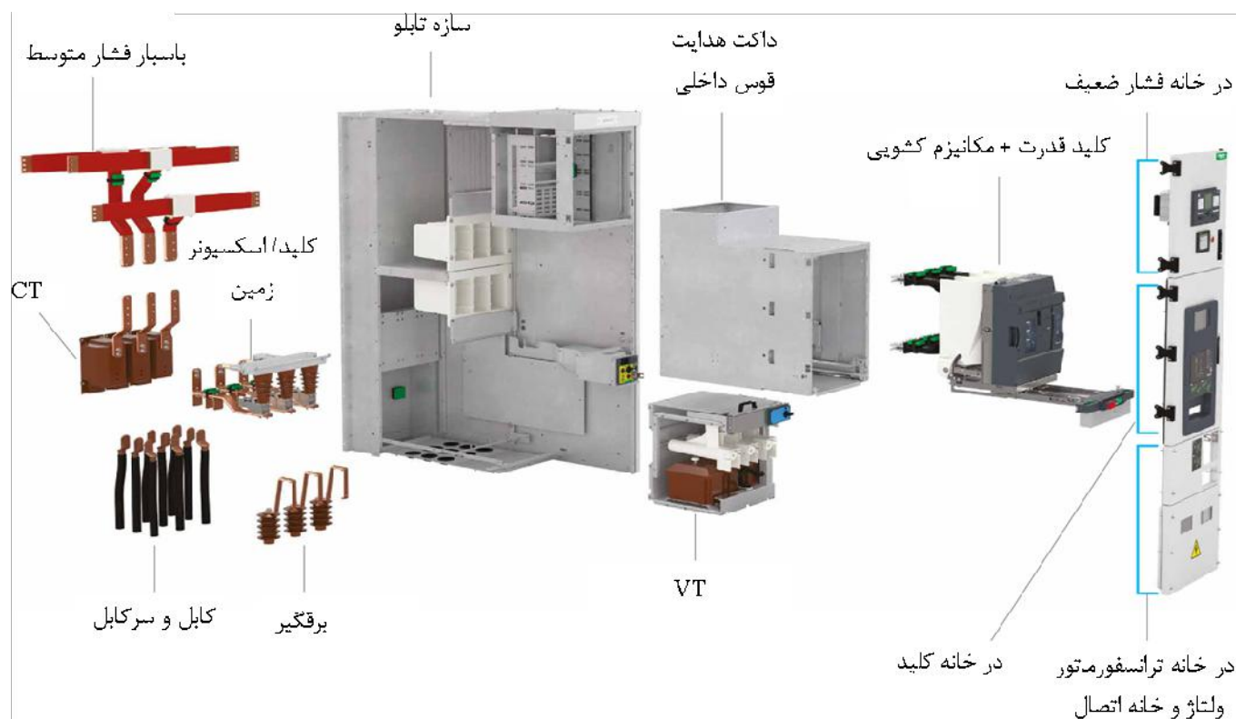
شکل ۷-۱۴- اجزا تابلو فشار متوسط نمونه
