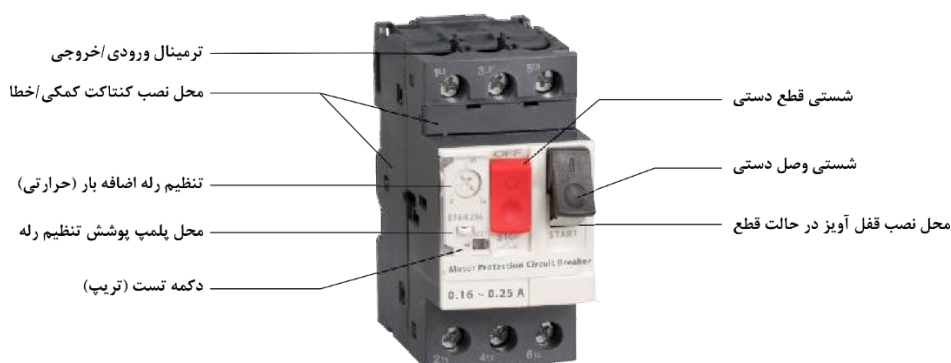
شکل ۶-۳۷- اجزای مختلف کلید محافظ موتور
