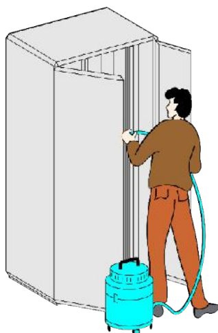
شکل ۶-۷۰- پاکسازی فضای داخل تابلو با استفاده از جاروبرقی
