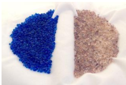
شکل ۸-۱۰- تغییر رنگ سیلیکاژل آبی پس از اشباع شدن از رطوبت
